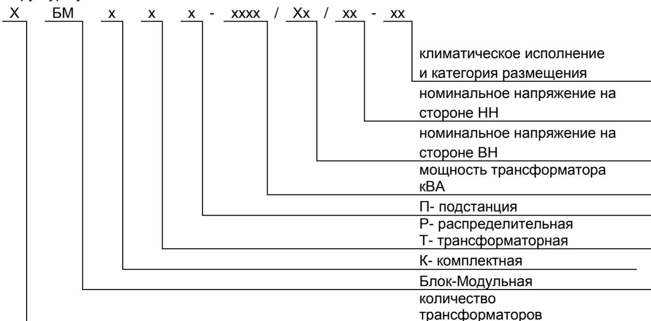
Пример условного обозначения БМКТП внутреннего обслуживания с двумя силовыми трансформаторами мощностью 1000 кВА, номинальным напряжением 10/0,4 кВ, климатическим исполнением У1:
