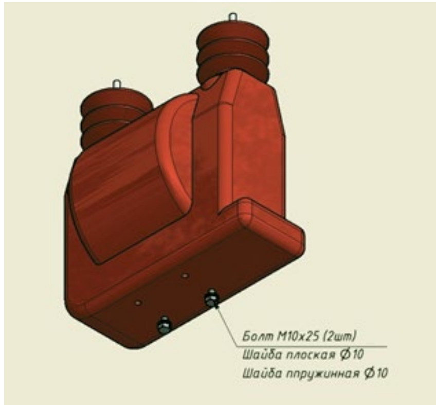
Рис. 4.17. Установка болтов для монтажа ТСН
