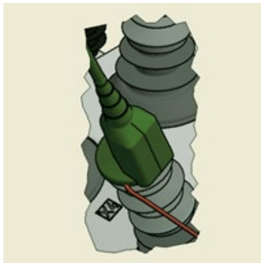
Рис. 4.21. Место подключения провода к коммутационному модулю в сборе
