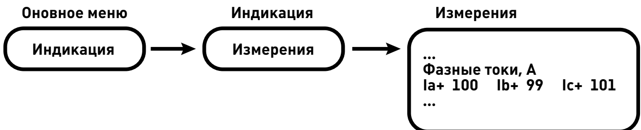
Рис. 5.7. Просмотр наличия токов с панели управления
