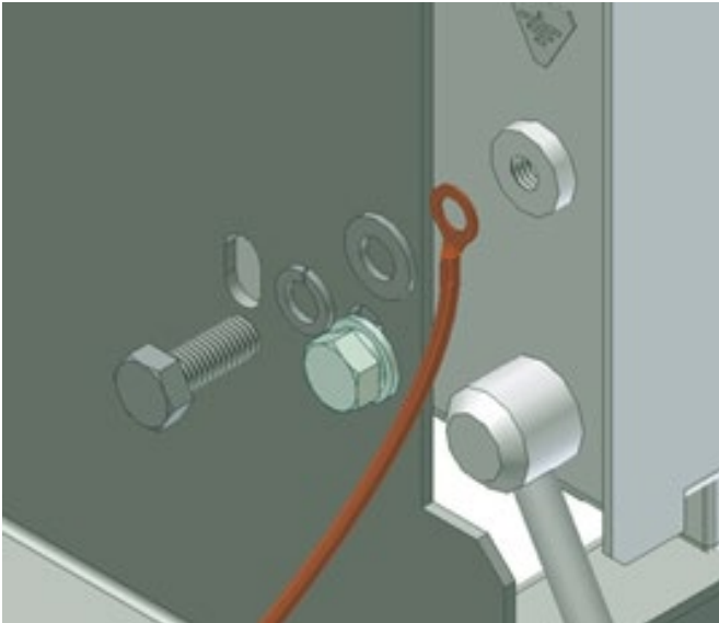
Рис. 4.30. Заземление коммутационного модуля
