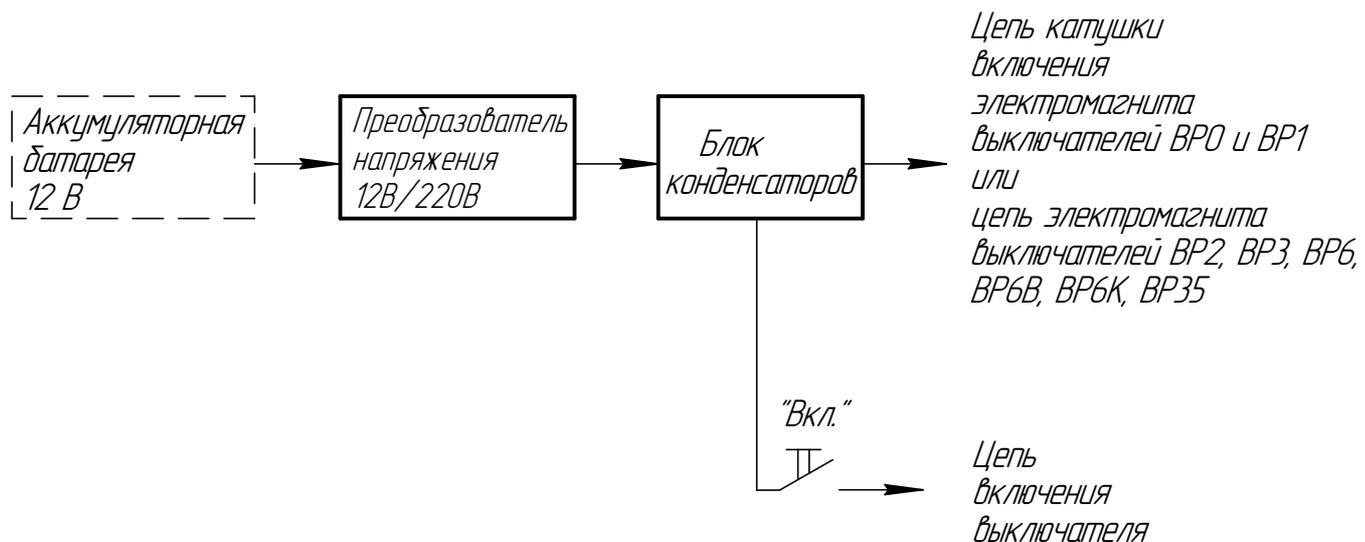
Рисунок В.2 - Структурная схема шкафа неоперативного включения
