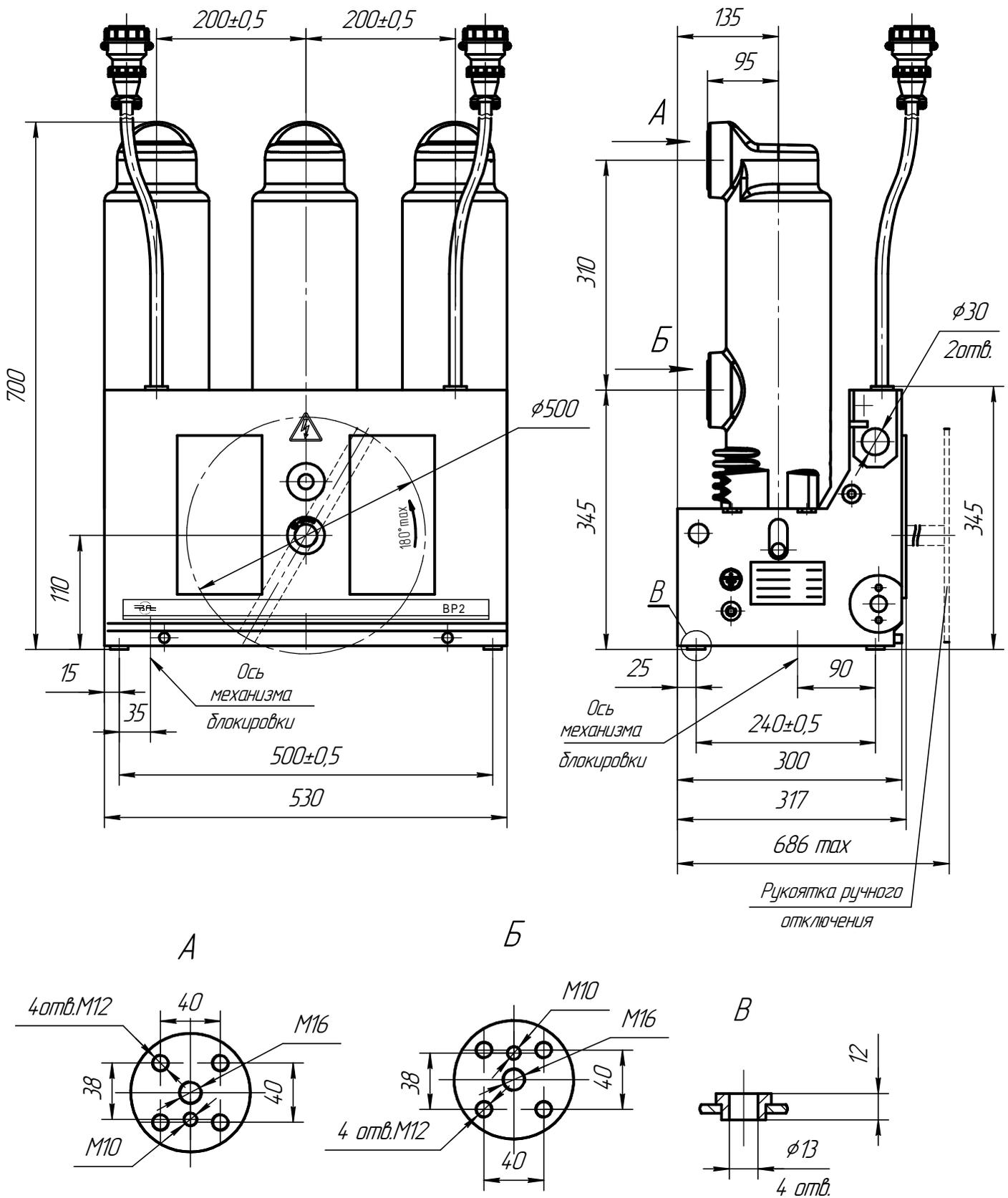
Рисунок А.3 - Габаритные, установочные и присоединительные размеры выключателей вакуумных серии BP2 на номинальные токи 1600 и 2000А
